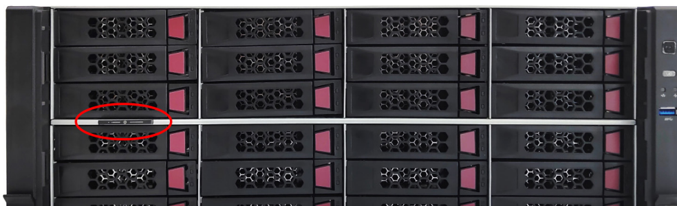
图4-2 抽拉式资产标签的位置（示例）
