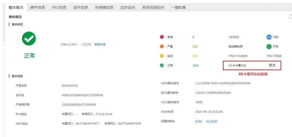
图7-125 HDM中显示SD卡扩展模块在位
