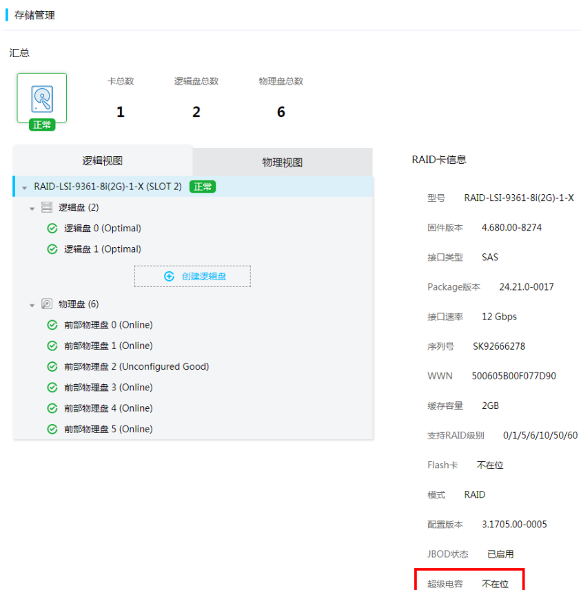
图7-48 存储控制卡配置信息
