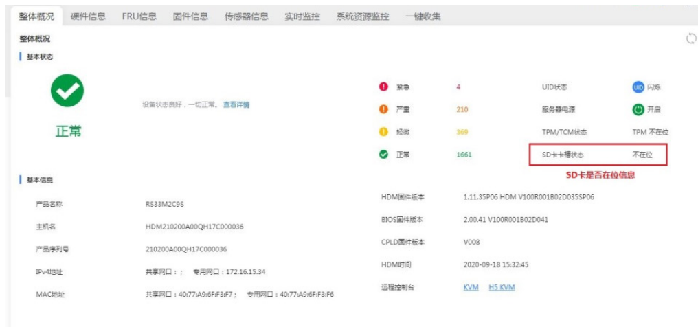
图7-126 HDM 中显示 SD 卡扩展模块不在位
