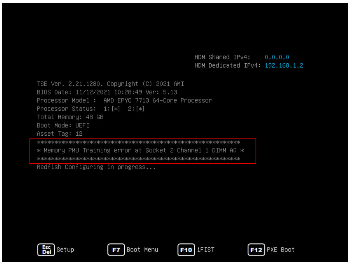
图8-9 AMD BIOS 启动阶段告警示例
