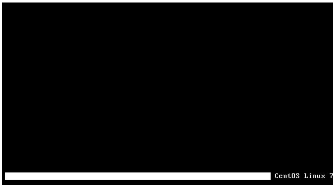
图8-7 操作系统引导时卡死
