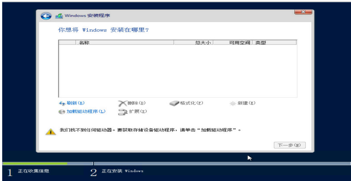
图8-3 无法识别硬盘示例图
